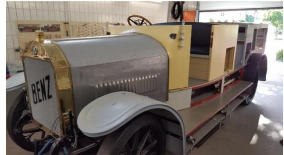
Bei der Restaurierung des Alten Benz ging es im Jahr 2020 hauptsächlich um die Fertigstellung der Motorhaube sowie die Lackierung der ersten Teile. In den nächsten Schritten wird nun das Fahrzeug Stück für Stück wieder auseinandergelassen, um große Teile des Aufbaus lackieren zu können.
