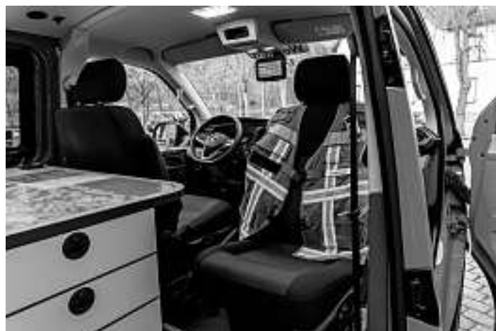
Der Fahrer- und Beifahrersitz kann gedreht werden, damit diese am Funkarbeitsplatz genutzt werden können.
