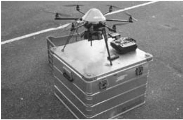
Mit der Drohne, einem gpx-gesteuerten Mikrokopter, können hochaufgelöste Luftbilder, aber auch Gebäudenahaufnahmen in luftiger Höhe gemacht werden.
