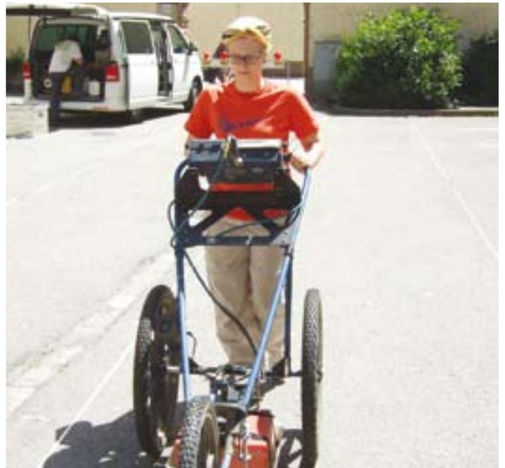
*Schritt für Schritt, Reihe für Reihe geht Archäologin Ulrike Wischnewski mit dem Bodenradar den Schlosshof ab und schickt elektromagnetische Wellen in den Untergrund. Die schweißtreibenden Temperaturen von über 30° im Schlosshof machte den Mitarbeitern von GGH nichts aus, sind sie doch Arbeiten in staubigen Gegenden in der Toskana, der Türkei oder Griechenland gewohnt.*
