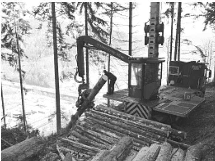
Wegen des Steilhanges sowie der unterhalb liegenden Bebauung musste teilweise ein Hochgebirgsseilkran eingesetzt werden, um die Stämme sicher aus dem unwegsamen Gelände zu holen.
